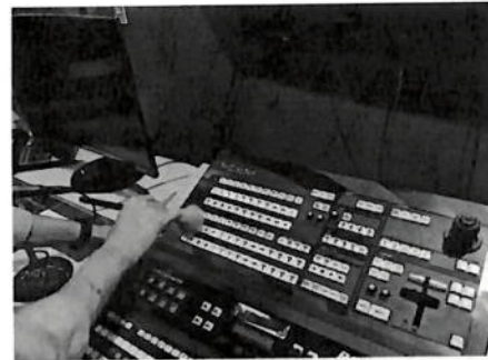
Remoción de polvo con brocha a la interface del tricaster
