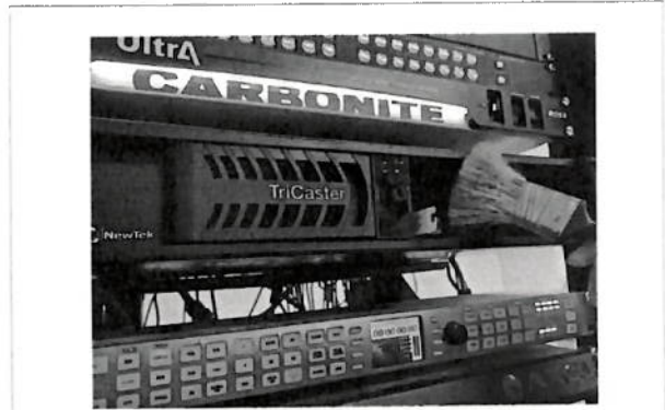
Remoción de polvo con brocha a la electrónica del sistema de croma
